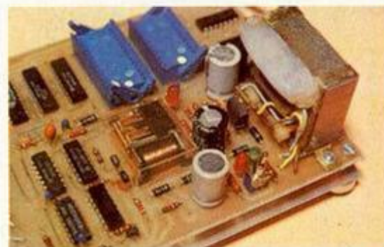
En los terminales de entrada de 220 V al transformador hay que colocar silicona como protección.
