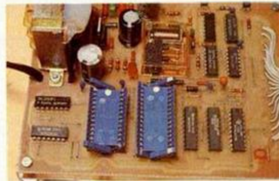
Detalle de la colocación de los zócalos de inserción nula.
