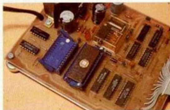
Las EPROM se insertan con suma facilidad. Préstese atención a su orientación según la muesca.
